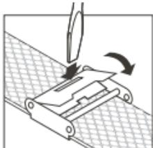
Para sujetar el cierre, vuelva a introducir el destornillador plano en la ranura rectangular y ajústelo hasta que cierre.
