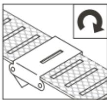
Vergewissern Sie sich, dass auf der Unterseite des Riemens die Vertiefung der Schnalle mit einer der Vertiefungen im Netzarmband übereinstimmt.
