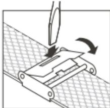
Per bloccare la fibbia in posizione, reinserire il cacciavite a taglio nella fessura rettangolare e abbassare la leva della fibbia.
