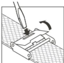
Para ajustar su correa de malla es necesario aflojar el cierre deslizante. Introduzca un destornillador plano en la ranura rectangular para abrir el elemento cierre.
