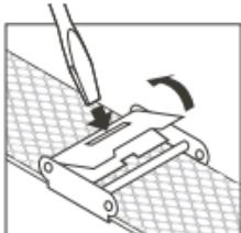
需要先松开滑扣才可以调整网丝表带。将一字型螺丝刀插入矩形槽中，然后扳起扣夹。
