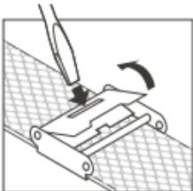
Чтобы отрегулировать отверстия ремешка, ослабьте подвижную застежку, вставьте отвертку с плоским жалом в прямоугольную щель и откройте зажимное устройство.
