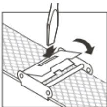
为固定扣环，请将一字型螺丝刀重新插入矩形槽中并将其扣紧
