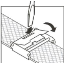
Чтобы зафиксировать застежку, вставьте отвертку с плоским жалом в прямоугольную щель и закройте зажимное устройство.
