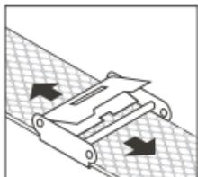
Una vez que el cierre está suelto puede deslizarse por la correa hasta la posición deseada.
