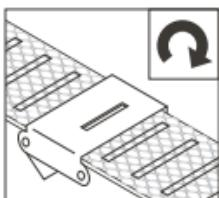
反转至表带底面，确保扣环上的槽与网带的其中一个槽对齐。
