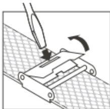
Um das Netzarmband einzustellen, müssen Sie den Schiebverschluss lösen. Führen Sie einen Schlitzschraubenzieher in den rechteckigen Schlitz ein und hebeln Sie die Klammer auf.
