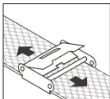
Jetzt kann der Schieber frei entlang des Riemens in die gewünschte Position verschoben werden.
