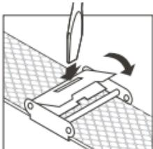
Pour fixer le fermoir, réinsérez votre tournevis à lame plate dans la fente rectangulaire et refermez-le.
