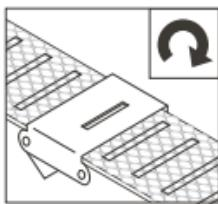
Sul lato inferiore del cinturino, assicurarsi che la scanalatura sulla fibbia sia allineata con una delle scanalature nella maglia.
