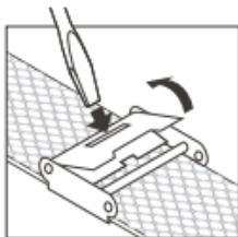
Per regolare il cinturino a maglie è necessario allentare la fibbia scorrevole. Inserire un cacciavite a taglio nella fessura rettangolare e sollevare la leva della fibbia.
