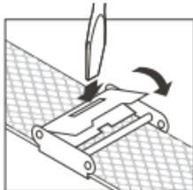
Um die Schnalle zu befestigen, positionieren Sie den Schlitzschraubendreher erneut in dem rechteckigen Schlitz und heben Sie die Schnalle zu.
